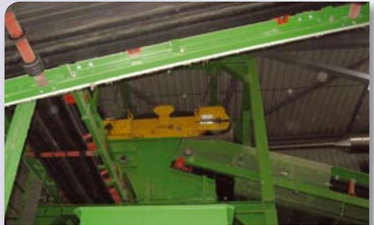
3) Magnetscheider zur Aussortierung der metallischen Fraktion
