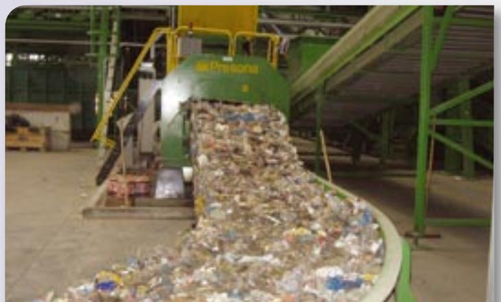
5) Kanalballenpresse: Ersatzbrennstoff aus heitwertreichem Material
